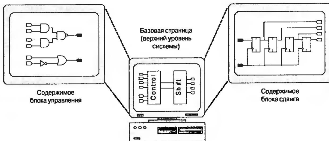
Рис. 8.13. Простая иерархическая принципиальная схема
