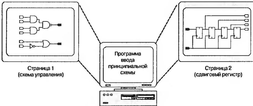
Рис. 8.12. Простая двухстраничная одноуровневая принципиальная схема
